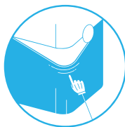
Prefiltro de tela opcional: Un prefiltro de tela captura las partículas más grandes y aumenta la vida útil del filtro principal.
