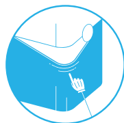
Pré-filtre en tissu optionnel: Un pré-filtre en tissu retient les particules les plus grosses, augmentant ainsi la durée de vie de l'appareil.
